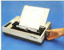
Fig. 1. Epson FX-80, modello FX-80. Epson FX-80, stampante a matrice di punti con un buffer di memoria di 8 K e un set di caratteri personalizzati.
